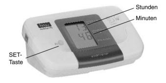
Wird die SET-Taste für ca. 30 Sekunden nicht betätigt, erfolgt automatisch der Wechsel in den Anzeigemodus Uhrzeit.
