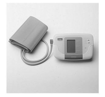
Stellen Sie den Schiebeschalter DRUCKVORWAHL auf den gewünschten Manschettendruck, der mindestens 30 bis 40 mmHg höher als der systolische (obere) Blutdruckwert sein sollte. Ist Ihnen dieser Wert unbekannt, stellen Sie bei der ersten Messung den Schalter auf 150 mmHg.
